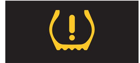
Beispiel-Anzeige eines indirekt oder direkt messenden Systems
