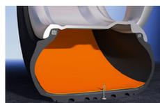
Bei der Seal-Technologie wird dafür gesorgt, dass eine Verletzung in der Reifenlauffläche gar nicht erst zum Luftdruckverlust führt. Durch ein Versiegelungsmittel wird die Reifenlauffläche provisorisch abgedichtet, um den Druckverlust, etwa aufgrund eines Nagels, zu verhindern. Seal Reifen sind mit allen handelsüblichen Felgen kompatibel und mit einem entsprechenden Symbol gekennzeichnet
