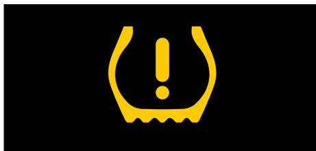
Beispielanzeige eines indirekt oder direkt messenden Systems
